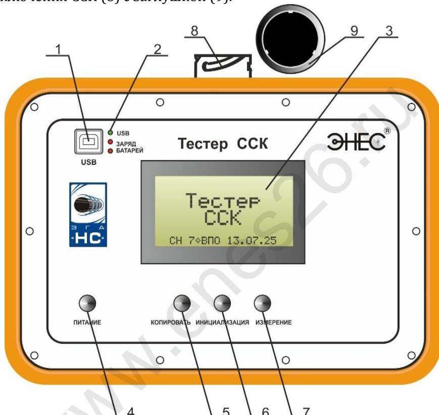
Сверху, под крышкой корпуса, находится разъем USB(1), индикаторы зарядки батарей и подключения к USB разъему компьютера(2), жидкокристаллический дисплей (3), кнопка включения Устройства (4) и кнопки управления Устройством («Копировать»-5, «Инициализация»-6, «Измерение»-7).
